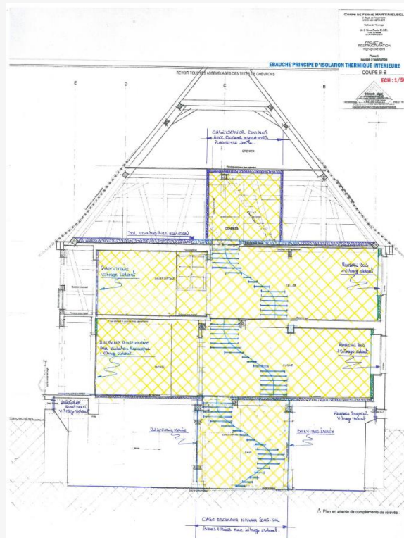
Figure 23 : En jaune : volume chauffé (source : étude thermique)
